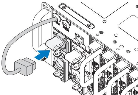
**NOTA:** En la ilustración siguiente se muestra la configuración correcta de los cables de alimentación de CA integrales al chasis y los zócalos de la unidad de fuente de alimentación (PSU).
