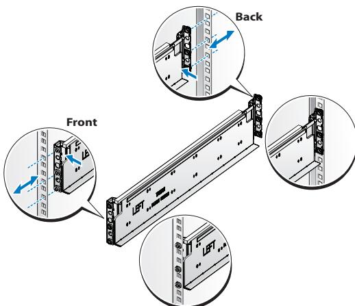
**3** Repita as etapas 1 a 2 para posicionar e instalar a extremidade da parte frontal na guia vertical.
