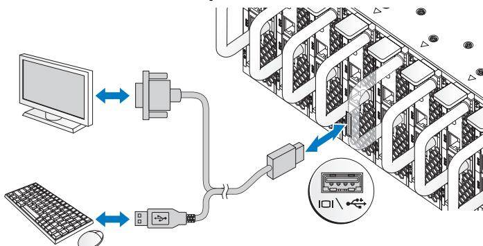
O conector na parte frontal do sistema tem um ícone indicando qual cabo deve ser conectado. Conecte um teclado, mouse ou monitor (opcional).
