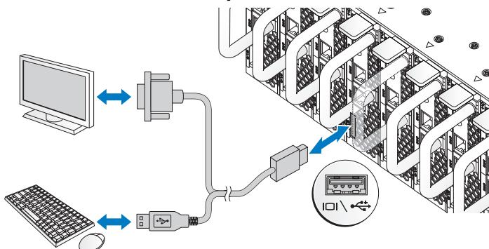
Le connecteur situé à l'avant de votre système comporte une icône indiquant quel câble brancher. Connectez un clavier, une souris ou un moniteur (facultatif).
