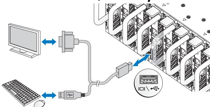
El conector de la parte frontal del sistema tiene un icono que indica qué cable debe conectarse. Conecte un teclado, un ratón o un monitor (opcional).
