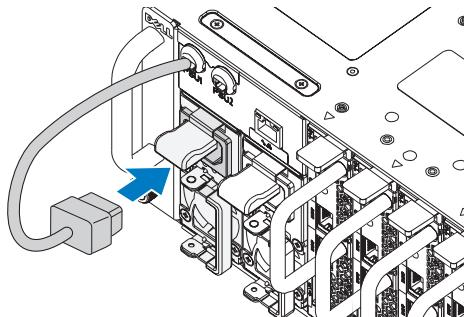
**NOTA:** Veja na ilustração a seguir a configuração correta dos cabos de alimentação CA do chassi nos soquetes de PSU (unidades de fonte de alimentação).
